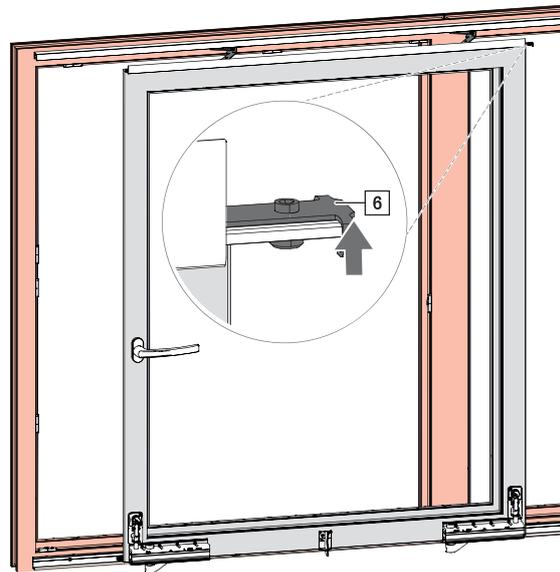
7. Gleitschere aus der Halteschiene schieben.
